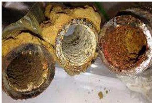
泄漏电流引起的管道腐蚀
