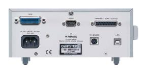
此外,在连接外部控制方面,GOM-804/805 提供一个 D-sub 25-pin 复合式的接口,根据选择的功能,进行相应的操作,如 Handler或Scan或EXTIO,分别提供连接分选机、外部开关或直接进行外部触发控制;最后,对于需求透过远程控制和获取测量结果,GOM-804/805 也提供了多样的接口选择,如 RS-232C、USB以及GPIB(GOM-804选配/GOM-805标配)接口。
