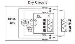
干电路 (Dry circuit),就是将测试电压和电流限制到不能引起接触点产生物理或电学变化的电路,常见的应用是接触阻抗的测量。依据 MIL-STD-1344 的方法 3002-1~低信号准位接触电阻,测试时必须限制最大开路电压在 20mV( 含 ) 以下,而短路电流则为 100mA 或更低的情况,以避免组件两端的电压过高,破坏了接触点表面的氧化层或薄膜,进而破坏测量的有效性。GOM-805 提供 3 个档位 (500m $\Omega$ :100mA/5 $\Omega$ :10mA/50 $\Omega$ :1mA)可将开路电压限制在 20mV,执行干电路测试。
