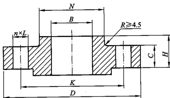
图 8.2.1 带颈平焊钢制管法兰(SO)尺寸
