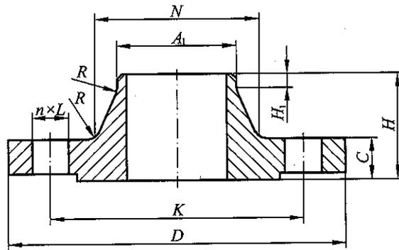
图 B.6.2-3 带颈对焊钢制夹套法兰
