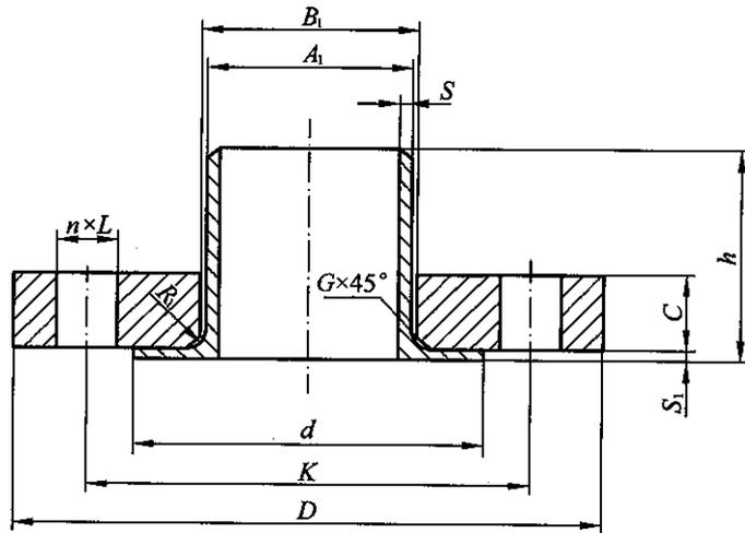
图 8.2.7 对焊环松套钢制管法兰
