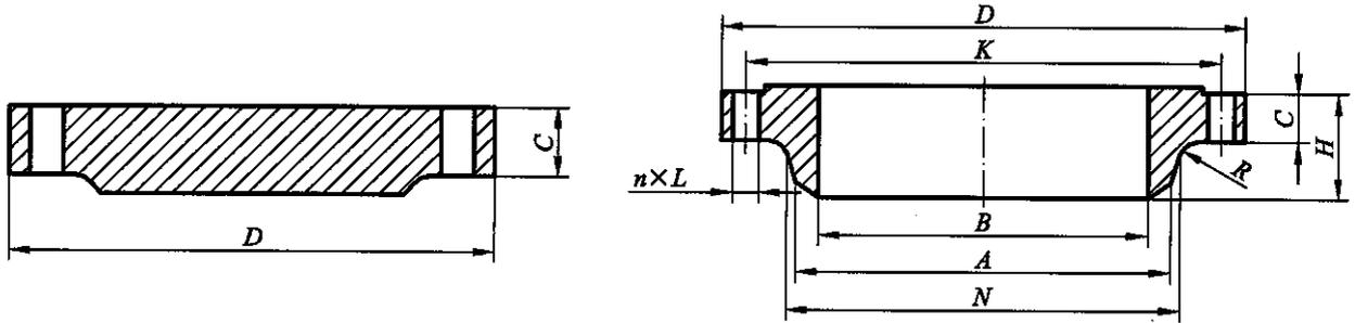
图 7.0.1 大直径法兰和法兰盖尺寸
