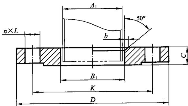
图 B.6.2-1 板式平焊钢制夹套法兰
