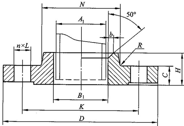
图 B.6.2-2 带颈平焊钢制夹套法兰
