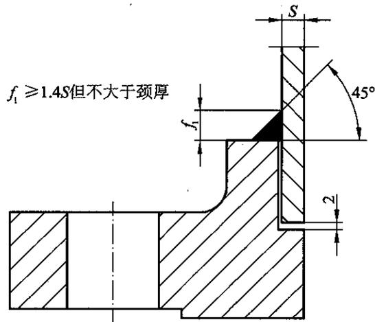
图 9.3 承插焊法兰与钢管连接的焊接接头
