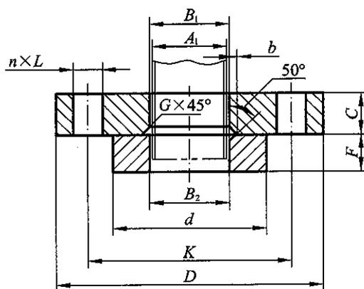
图 8.2.8 平焊环松套钢制管法兰
