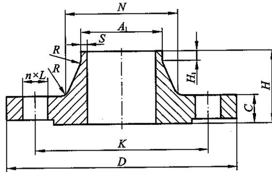
图 8.2.3 带颈对焊钢制管法兰
