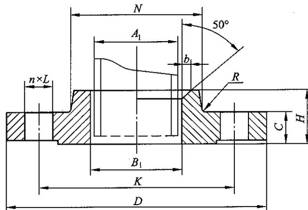
图 8.2.2 带颈平焊钢制管法兰
