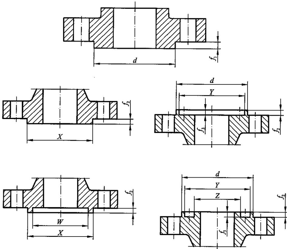
图 B. 6. 1 夹套法兰密封面尺寸
