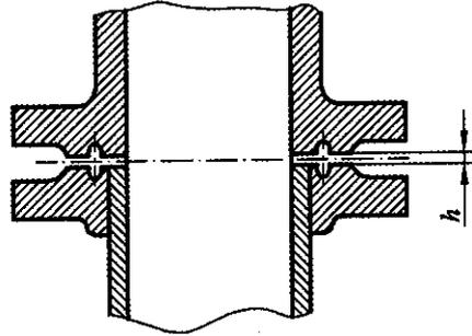
图 F 环连接面法兰间近似距离
