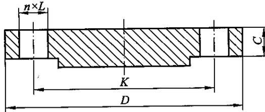
图 8.2.8 钢制管法兰盖(BL)尺寸
