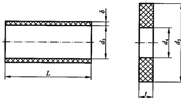
图 B.0.2 绝缘衬套和绝缘垫圈
