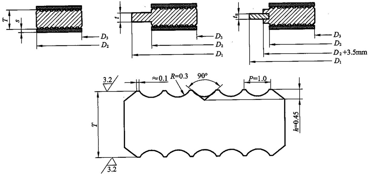
图 4 具有覆盖层的金属齿形垫尺寸
