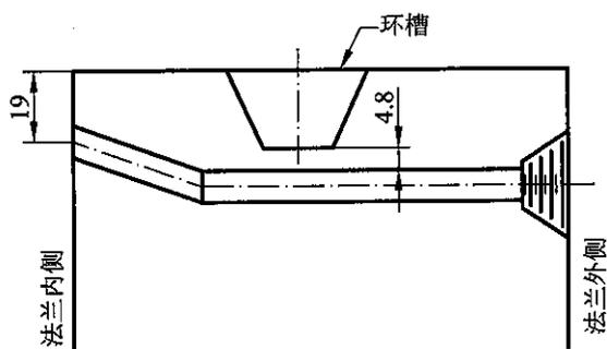
图 A.7.3 环连接面法兰用测压孔结构
