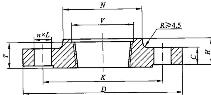
图 8.2.6 螺纹钢制管法兰(Th)尺寸
