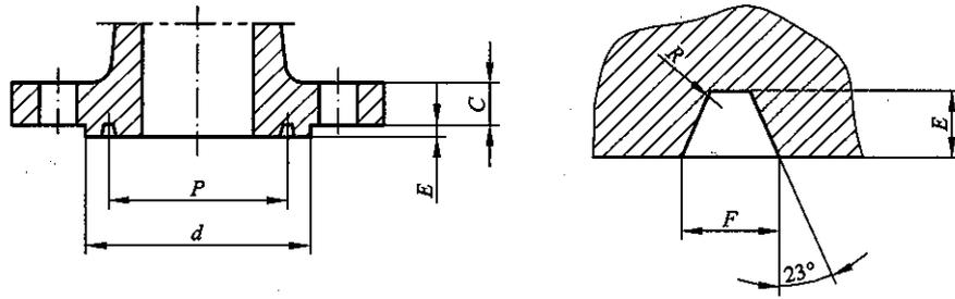
图 3.2.5-2 环连接面的密封面尺寸
