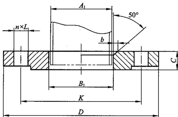
图 8.2.1 板式平焊钢制管法兰
