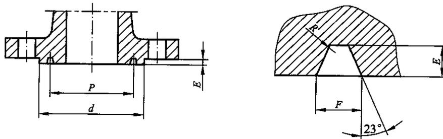
图 3.2.7-2 环连接面(RJ)法兰的密封面尺寸
