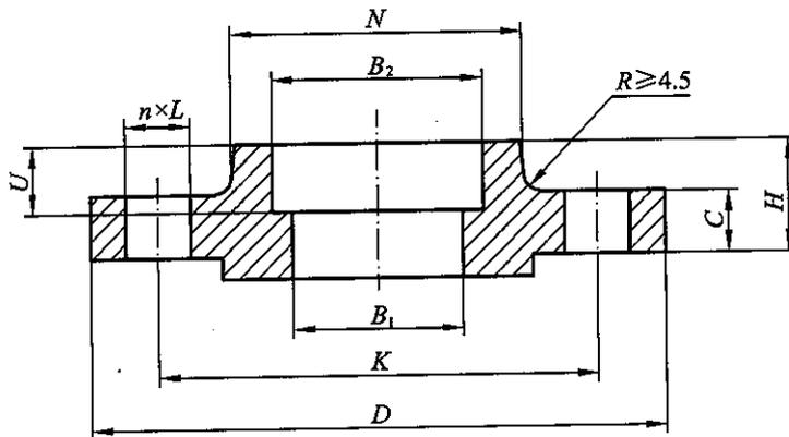
图 8.2.5 承插焊钢制管法兰(SW)尺寸
