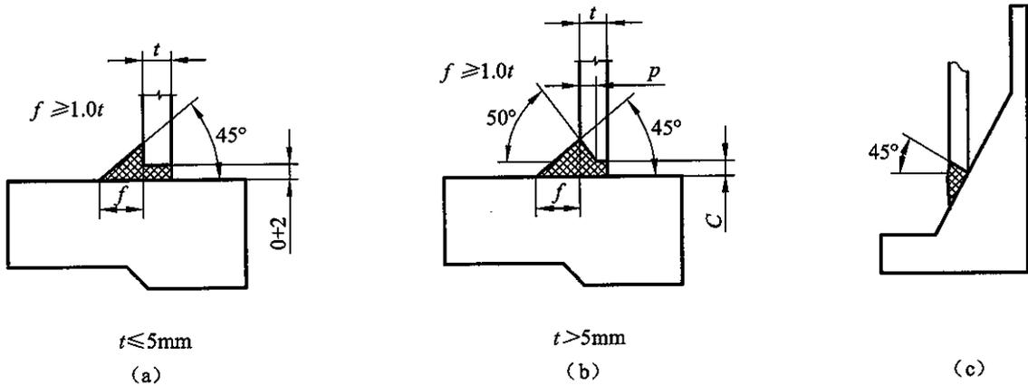
图 B.7.2 外管与夹套法兰的焊缝尺寸
