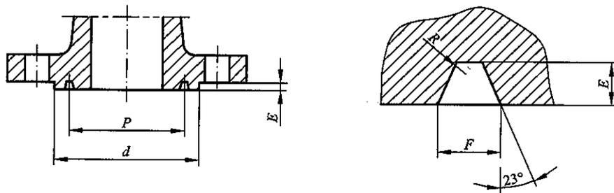
图 3.2.5-3 环连接面(RJ)法兰的密封面尺寸
