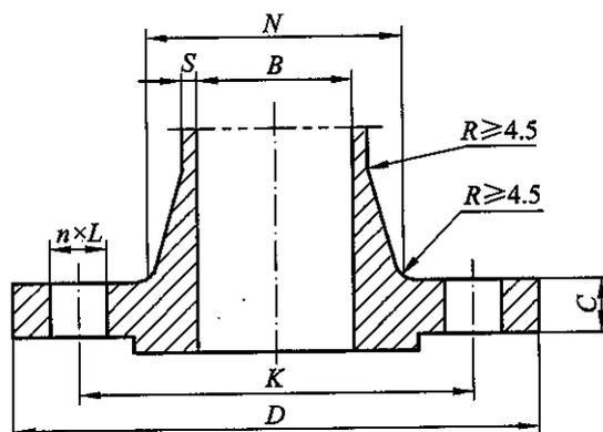
图 8.2.4 整体钢制管法兰(IF)尺寸
