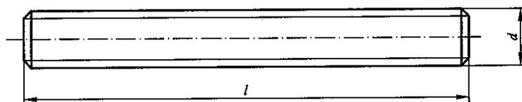
图 3.3.1 全螺纹螺柱
