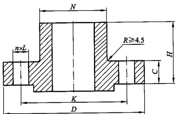
图 8.2.3 长高颈钢制管法兰(LWN)尺寸
