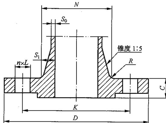
图 8.2.4 整体钢制管法兰
