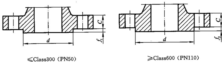
图 3.2.5-1 突面(RF)法兰的密封面尺寸
