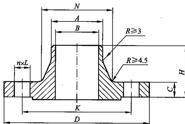
图 8.2.2 带颈对焊钢制管法兰(WN)尺寸
