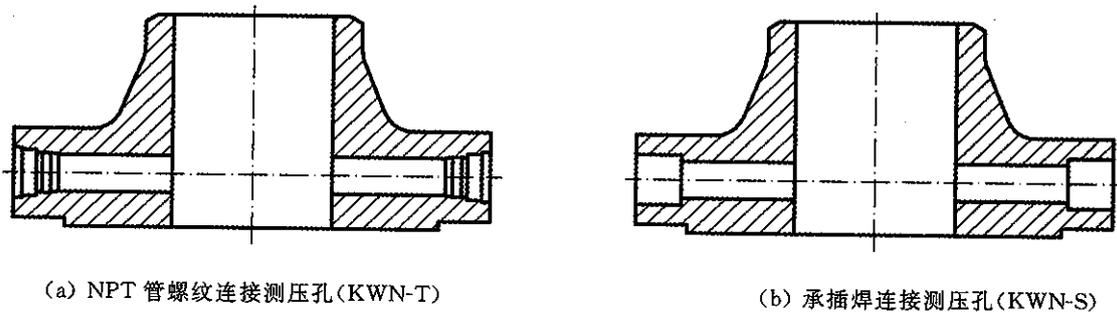
图 A.3-1 带颈对焊孔板法兰类型
