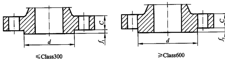
图 3.2.7-1 突面法兰的密封面尺寸
