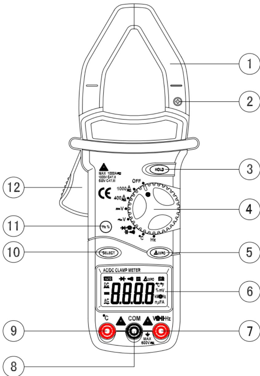
1. 交直流电流钳口：拾取交直流电流。
