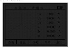
注:将通讯软件打开,按功能键"通讯",进入连接界面;点击通讯 软件进行抄录数据;
