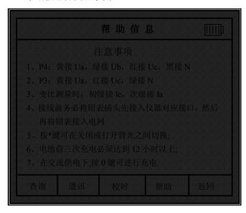
11) 查询界面显示图: P4 测量下按 键可显示查线结果
