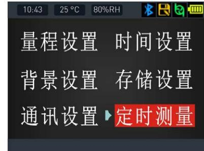
默认的测量时间是0秒，如果不修改这个数值，此功能不起作用，当修改为一定的数值，此功能开始起作用，若要使用定时测量的功能。一般情况需要把数值修改为30到60秒，按一下泵的开关“PUMP”键开始测量，达到设定的时间就停止测量。定时测量的界面：显示屏顶部显示设定的时间和剩余时间，如右图：
