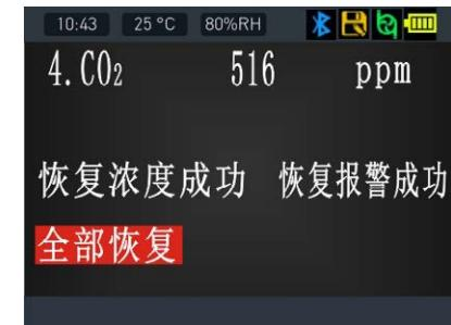
当设置错误或测试浓度不准确时需要进行恢复出厂的操作，如果是人为因素造成的不良可以得到恢复，可以恢复出厂的参数：零点校准值、浓度校准值、报警值、报警方式、报警模式、最大量程。
