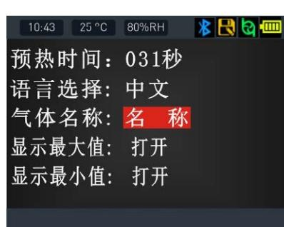
**显示最大值:** 选择打开就在单通道界面显示本次测量的最大值和上次测量的最大值, 如右图:
