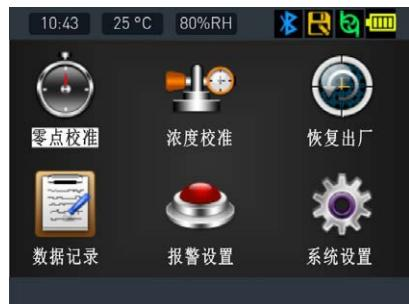
通过“◀”键和“▶”键选择要校准的通道，按“■”键进行零点校准，如下图：
