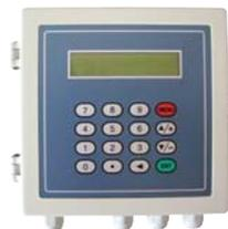
我公司生产的二次仪表实质为一个串口键盘操作器，其操作方法与并口键盘显示器相同（详见下一节并口键盘操作），并可为主板提供所需的24VDC电源，但只能使用在单机环境下，而不能应用于超过两台TDS-100的数据采集网络中，当用户既需要把TDS-100连接于RS485网络中，又需要使用RS485串口键盘显示器显示测量结果，需网络型键盘显示器（研发中）。
